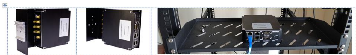
Рис.3 Крепление СТВ Метроном-500 (Метроном-500/NTP) для DIN-рейки и установка на полку
