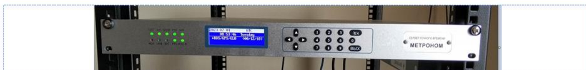
Рис.4 Крепление СТВ Метроном-810 в стойку 19"
