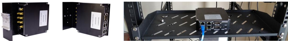
Рис.3 Крепление СТВ Метроном-500 (Метроном-500/NTP) для DIN-рейки и установка на полку
